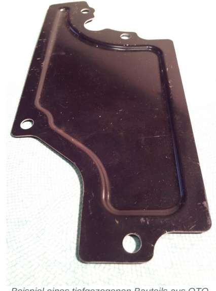
Beispiel eines tiefgezogenen Bauteils aus OTO-Akustikblech
