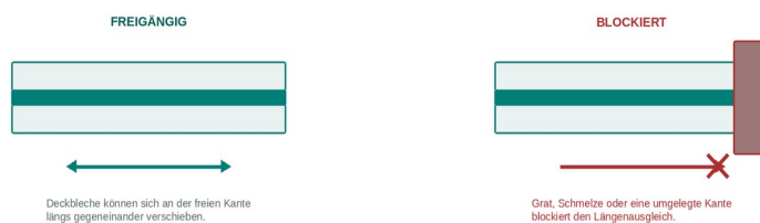
Abb. 6 – Freie und blockierte Schnittkante
